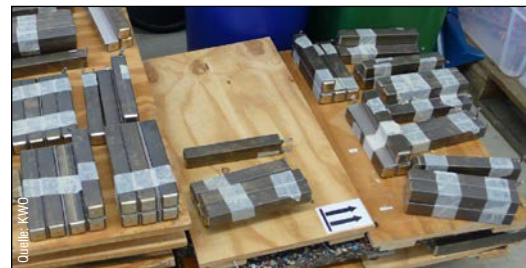
Quelle: KWO Widergeburt: „Tote“ Natrium-Nickel-Batterien norwegischer Think-E-Mobile werden stationäre Speicher.
